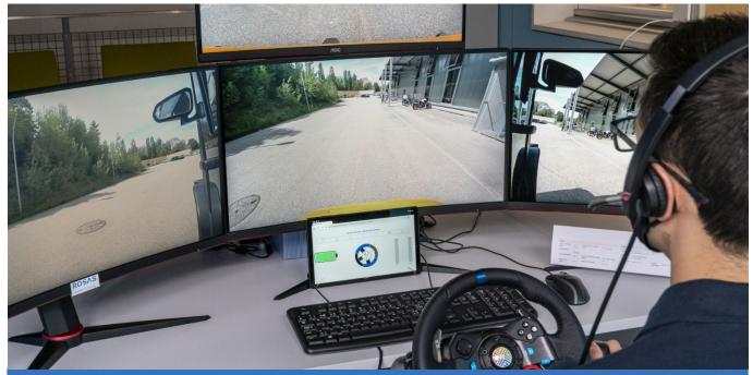
Développement et mise en place d'un concept de téléopération centralisée permettant de piloter à distance des véhicules automatisés et connectés sur la base des exigences de sûreté et de cybersécurité
